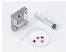
Elle combine les fonctions de l'électrolyseur et de la pile à combustible en un seul et même dispositif.
