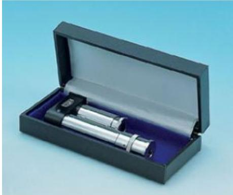
**Spectroscop à main avec échelle de longueurs d'ondes et fente réglable**
