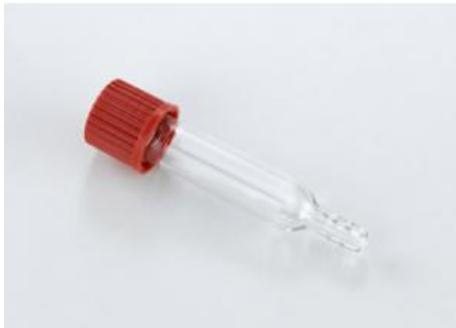
Avec 1 raccord fileté GL 18 à joint en silicone (Ø int. : 8 mm) et joint en Téflon fixé par bride.
