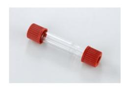
Avec 2 raccords filetés GL 18 à joints en silicone (Ø int. : 8 mm) et joints en Téflon fixés par bride.
