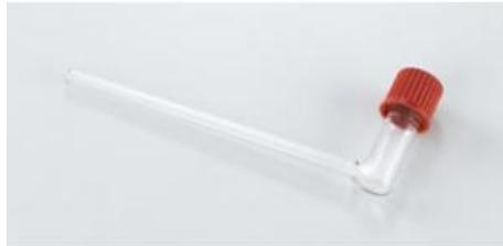
Tube en verre coudé pour raccorder les pièces en verre CPS à la verticale sur les plaques d'expérimentation (sur deux étages). Branche courte à raccord fileté GL 18 avec joint en silicone ( $\varnothing$  int. : 8 mm) et joint en téflon fixé par bride.
