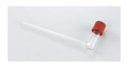
Tube en verre coudé pour raccorder les pièces en verre CPS à la verticale sur les plaques d'expérimentation (sur deux étages). Branche courte à raccord fileté GL 18 avec joint en silicone (Ø int. : 8 mm) et joint en téflon fixé par bride.
