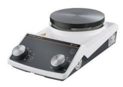
L'agitateur magnétique avec plaque chauffante est commandé par deux têtes rotatives. Le réglage de la vitesse et de la température s'effectue à l'aide d'une échelle graduée. Les valeurs maximales sont de 1 400 tr/min et 300 °C.
