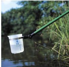
Écope de puisage pour le prélèvement d'échantillons à la surface de l'eau.
