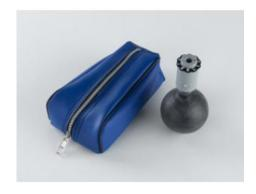
Pour la mesure rapide et exacte des concentrations de gaz et de vapeur dans l'air. Le détecteur de gaz se compose d'une poire et d'un support pour les tubes indicateurs. Ces tubes contiennent un système réactif provoquant un virage de la coloration en présence de la substance à mesurer. Fourni avec un mode d'emploi détaillé.
