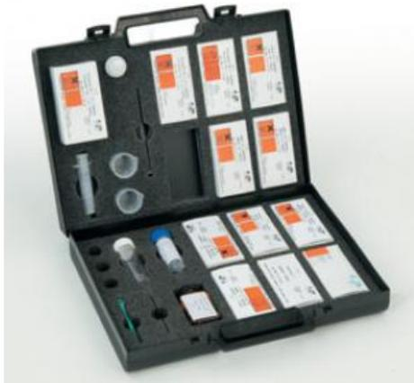
Utilisé avec le photomètre à immersion S ( 524 069 ) et le système CASSY, l'assortiment 1 de réactifs permet de mesurer 8 substances contenues dans des échantillons d'eau. Les réactifs sont fournis sous forme de pastilles. 100 dosages peuvent être effectués par réactif.
