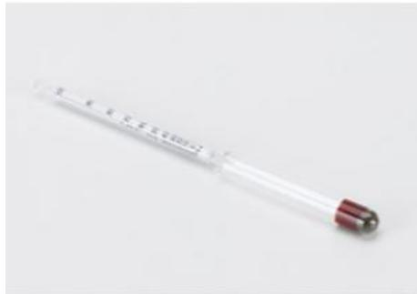
Pour déterminer la masse et le volume en %, sans thermomètre.
