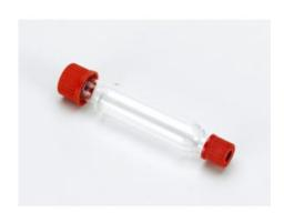
À remplir de granules de CaCl 2 pour la combustion du butane.
