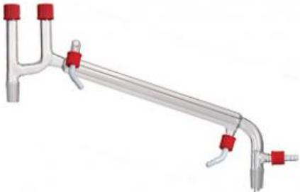
**Pont de distillation de Claisen avec olives pour le branchement de l'eau de refroidissement**
