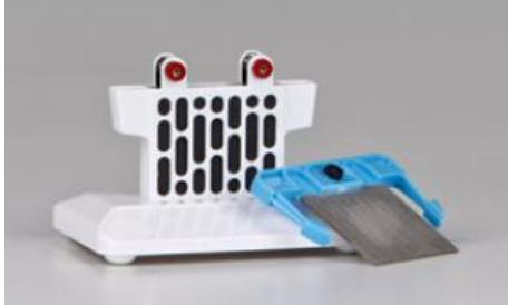
Couple galvanique pour la production d'électricité avec du magnésium et de l'air.
