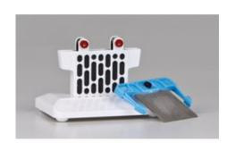
Couple galvanique pour la production d'électricité avec du magnésium et de l'air. Le matériel contient l'élément air et une électrode de magnésium. Cette pile magnésium-air est aussi caractérisée de pile à combustible à eau salée.
