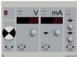
Instrument de mesure et alimentation à usage universel permettant de réaliser un grand nombre d'expériences dans le domaine de l'électrochimie.
