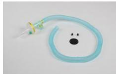
Utilisés avec l'adaptateur spiromètre ( 524056 ), l'adaptateur O 2 ( 524052 ) et l'électrode de mesure de l'oxygène ( 667458 ), les accessoires servent à étudier la consommation d'oxygène.
