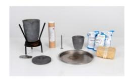
L'assemblage de deux pièces de métal par soudage aluminothermique (thermite) revêt une grande importance tant sur le plan technique que chimique. La réduction de l'oxyde de fer avec l'aluminium conduit à des températures très élevées : le fer réduit fond et permet, ce faisant, de souder deux extrémités métalliques l'une à l'autre.
