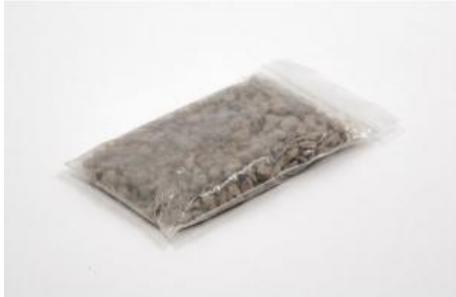
Pour éviter la distorsion d'ébullition lors du chauffage de solutions aqueuses.
