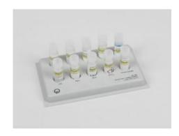
Pour des observations spectroscopiques ; sels métalliques permettant l'identification de substances par la coloration caractéristique d'une flamme. Les sels sont conditionnés dans des petits tubes fermés, clairement disposés sur un plateau.
