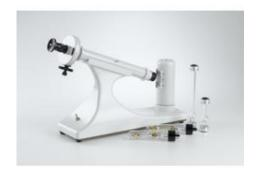
Pour la détermination de la concentration de solutions optiquement actives. Carter métallique stable avec logement légèrement incliné pour les tubes polarimétriques. Lampe au sodium intégrée avec porte-filtre. Oculaire central avec correction de l'acuité visuelle et 2 petites loupes.
