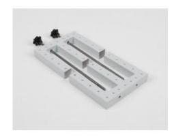
Adapté aux bobines (590821 - 59089) pour la réalisation d'un transformateur triphasé ; seulement pour très basses tensions.
