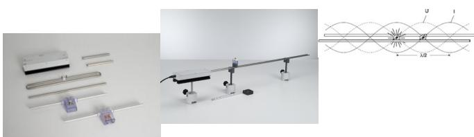
Avec une fréquence de service de 433,92 MHz (bande UHF des 70 cm/ bande ISM (Industrial, Scientific, Medical) pour l'étude expérimentale des conditions de propagation d'ondes électromagnétiques (radiodiffusion) dans l'espace libre et dans des milieux diélectriques, par ex. dans l'eau et sur des systèmes à fils de Lecher.
