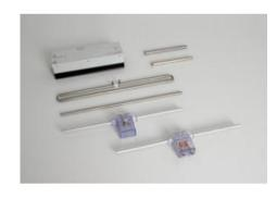
Avec une fréquence de service de 433,92 MHz (bande UHF des 70 cm/ bande ISM (Industrial, Scientific, Medical) pour l'étude expérimentale des conditions de propagation d'ondes électromagnétiques (radiodiffusion) dans l'espace libre et dans des milieux diélectriques, par ex. dans l'eau et sur des systèmes à fils de Lecher.
