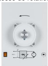
Moteur universel avec poulie et commande par découpage de phase pour le réglage en continu de la vitesse de rotation de 0 à 3000 tr/min.
