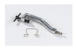
Agrafe d'assemblage pour fixer le joug sur le noyau en U du transformateur d'expérimentation. La pince à ressort sert à maintenir la bobine pour la réalisation d'un électro-aimant.
