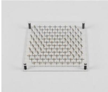
Pour démontrer les phénomènes complexes se déroulant dans le réseau cristallin de matériaux ferromagnétiques, pour traiter les domaines de Weiss, les sauts de Barkhausen, la saturation, le cycle d'hystérèse, le point de Curie et l'influence de l'agitation thermique.
