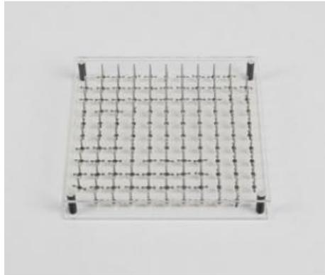
Pour démontrer les phénomènes complexes se déroulant dans le réseau cristallin de matériaux ferromagnétiques, pour traiter les domaines de Weiss, les sauts de Barkhausen, la saturation, le cycle d'hystérèse, le point de Curie et l'influence de l'agitation thermique ; avec plaque de base et plaque couvercle transparentes.
