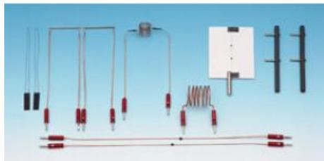
Pour visualiser les lignes de champ électromagnétiques de conducteurs parcourus par un courant, la déviation d'une aiguille aimantée dans le champ d'un conducteur parcouru par un courant, les forces exercées entre des conducteurs parallèles parcourus par un courant, un modèle d'appareil de mesure à cadre mobile et de wattmètre, etc.
