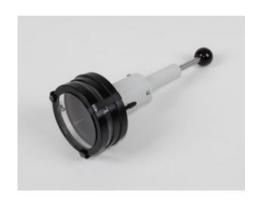
Pour visualiser les trajectoires de particules a ; brève durée de condensation du mélange alcool/vapeur d'eau dont la sursaturation par détente adiabatique est obtenue au moyen d'une pompe à air manuelle ; couvercle avec fenêtres en verre acrylique pour l'observation et le passage de la lumière ; douilles de raccordement pour tension de drainage servant à désioniser et support pour préparation de radium (559596).
