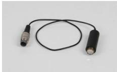
Tube compteur Geiger-Müller à auto-extinction, dans boîtier en plastique, avec fenêtre en mica très mince permettant aussi l'enregistrement d'un rayonnement  $\beta$  mou. Muni d'un câble solidaire. Livré avec capuchon de protection pour la fenêtre en mica.
