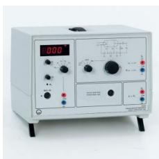
Sert à réaliser l'expérience de Franck et Hertz avec le tube au mercure ( 555 854 ) ou le tube au néon ( 555 8701 ) :
