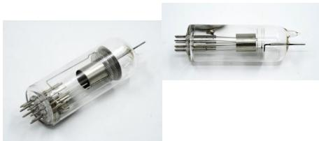
Pour mettre en évidence l'émission d'énergie discontinue d'électrons libres par collision avec des atomes de néon et leurs états d'énergie discrets ou pour déterminer la première énergie d'excitation.
