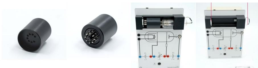
Adaptateur pour insérer un tube néon Franck-Hertz 555 8701 (au lieu de 555 870) dans un support 555 871.
