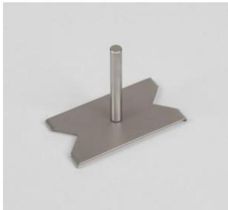
Pour installer le four électrique tubulaire ( 555 81 ) sur un banc d'optique.
