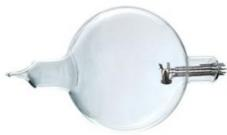
Tube avec cathode chaude à oxyde à chauffage indirect, cylindre de Wehnelt et anode conique ; avec écran semi-circulaire et paire de plaques pour la déviation électrostatique d'un faisceau.
