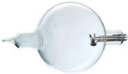
Tube avec cathode chaude à oxyde à chauffage indirect, cylindre de Wehnelt et anode conique ; avec écran semi-circulaire et paire de plaques pour la déviation électrostatique d'un faisceau.
