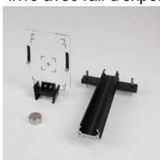
Pour l'appareil à rayons X ( 554 800 et 554 801 ), avec échelle sériographiée pour le positionnement défini des films pour les radioscopies, les clichés de Laue et de Debye-Scherrer ; livré avec rail d'expérimentation à échelle graduée en millimètres et diaphragme à trou (D = 1 mm) à placer sur le collimateur à fente.
