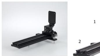
Pour le positionnement et l'ajustage précis du capteur pour radiographie ( 554828 ) dans l'appareil à rayons X ( 554800 ou 55481 ).
