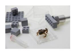
Permet la fixation d'objets au goniomètre en vue d'un examen tomodensitométrique ; comprend plusieurs objets. Le jeu de briques lego est conçu de manière à pouvoir également servir de porte-objets sur lequel il suffit de coller les petits objets à examiner.
