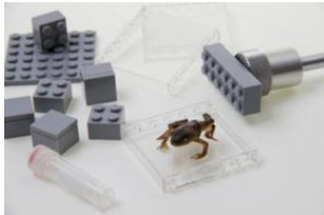
Permet la fixation d'objets au goniomètre en vue d'un examen tomodensitométrique ; comprend plusieurs objets. Le jeu de briques lego est conçu de manière à pouvoir également servir de porte-objets sur lequel il suffit de coller les petits objets à examiner.
