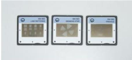
3 modèles d'essai (traits, mire de siemens, diaphragme à trou) pour déterminer le pouvoir de résolution du module de tomodensitométrie (554 821), ou du capteur pour radiographie ( 554 828 ) ainsi que la taille du point focal du tube à rayons X.
