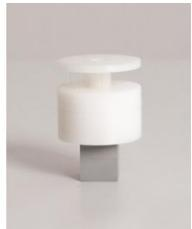
Corps d'essai pour la tomodensitométrie constitué de plusieurs couches pour l'estimation du pouvoir de résolution avec un contraste important et faible, pour la détermination de différents coefficients d'absorption (unités Hounsfield) et pour la production d'artefacts métalliques.
