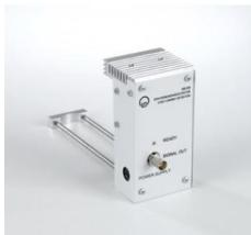
S'utilise dans l'appareil à rayons X ( 554 801 ) et en association avec le Sensor-CASSY ( 524 013 ) et l'adaptateur AMC ( 524 058 ) pour le relevé de spectres de rayons X résolus en énergie.
