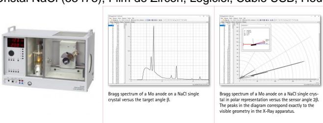
Appareil complet commandé par microprocesseur avec tube de Mo et goniomètre pour la réalisation de nombreuses expériences du domaine de la physique des rayons X.
