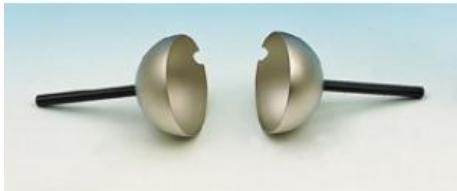
Pour le montage d'un condensateur sphérique avec la sphère sur support isolant ( 543021 ).
