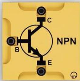
Composant avec 3 douilles de sécurité pour câbles ou cavaliers ( 539000 ). S'utilise sur le tableau magnétique ( 301301 ).
