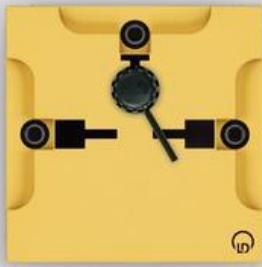
Composant avec 3 douilles de sécurité pour câbles ou cavaliers ( 539000 ). Utilise sur le tableau magnétique ( 301301 ).
