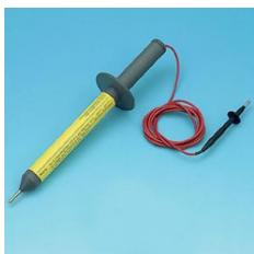
Résistance série pour hautes tensions avec poignée isolante pour la mesure de tensions continues inoffensives délivrées par des sources de haute tension couramment utilisées dans l'enseignement scolaire.
