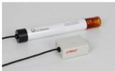
Associé à CASSY ( 524013 , 524006 , 524005W , 524018 ) ou à l'instrument de mesure universel de Chimie ( 531836 ) et aux réactifs appropriés ( 6662600 , 6662601 , 6662603 , 6662604 ), le photomètre à immersion S permet de mesurer les polluants et la turbidité dans des échantillons d'eau.
