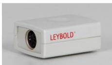
Utilisé avec le capteur de conductivité ( 529670 ), il permet de mesurer la conductivité et la température avec CASSY ( 524013 , 524006 , 524005W , 524018 ) ou l'instrument de mesure universel Chimie ( 531836 ).
