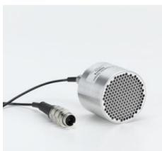
Tube compteur Geiger-Müller à grande surface active pour la mesure et l'enregistrement à haute sensibilité de sources radioactives très faibles ; convient particulièrement bien pour les travaux pratiques avec des sources radioactives faibles.
