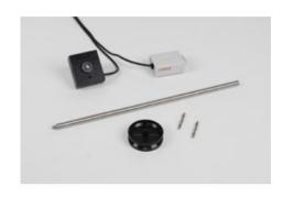
Pour la mesure sans frottement de mouvements de rotation, de déplacements linéaires, d'amplitudes, de périodes et de fréquences de rotation avec le Sensor-CASSY (524013), le Pocket-CASSY (524006, 524018) ou l'Instrument de mesure universel Physique (531835).
