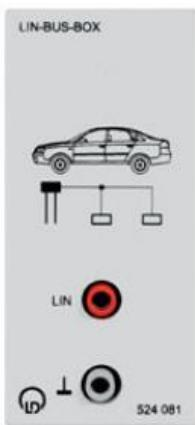
Se branche à un bus LIN pour le relevé et l'exploitation du signal du message avec un oscilloscope - avec possibilité de déclenchement sur un identificateur librement sélectionnable - et l'analyse simultanée du protocole.
