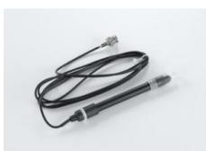
Avec connecteur BNC et câble solidaire. S'utilise avec l'adaptateur chimie ( 524067 ) ou le connecteur adaptateur pH S ( 5240672 ) combiné à CASSY ( 524013 , 524006 , 524005W , 524018 ) ou à l'instrument de mesure universel Chimie ( 531836 ).
