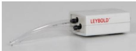
Pour la mesure de très petites différences de pression avec CASSY ( 524013 , 524006 , 524018 , 524005W ) ou les instruments de mesure universels ( 531835 , 531836 , 531837 ), par ex. pour les expériences sur l'écoulement dans le tunnel aérodynamique ( 37312 ) ou le tube de Venturi (de 373091 ).
